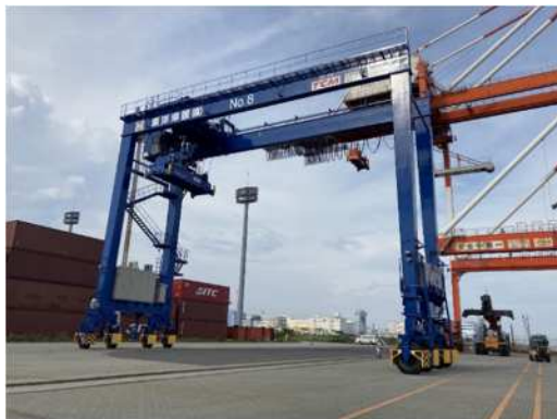
図 川崎港コンテナターミナルに導入された脱炭素型RTG
