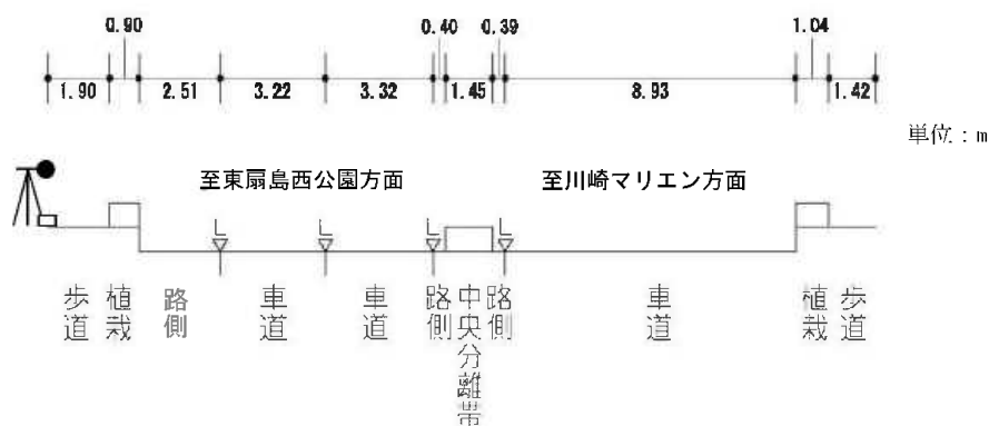
図 3-3-2(4) 道路断面図 (地点 d 40 号荷捌地)
