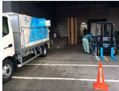
燃料(水素)充填作業
