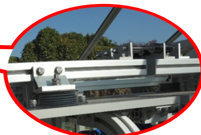
フレーム上部 防振ゲルと連結ダンパー
