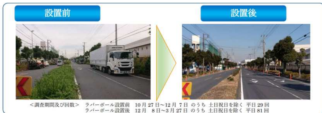
図 大型車の路上駐停車抑制対策(ラバーポール)の設置効果
