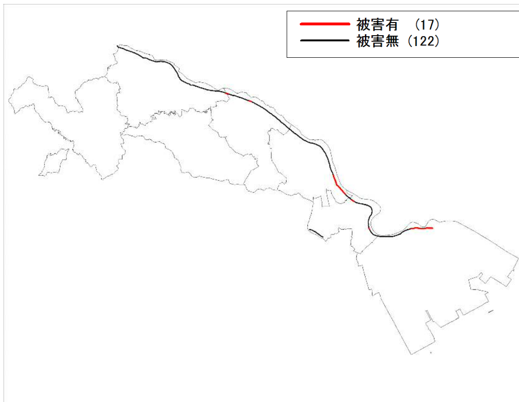
図 4. 3-2 (1) 河川堤防の被害結果 (H24 川崎市直下の地震)
