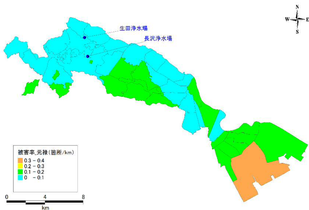
図 8.1-17 中ブロックごとの配水管被害率（全口径） （上：H24 川崎市直下の地震、下：元禄型関東地震）
