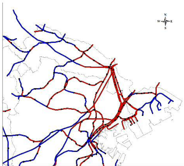
地震発生直後の鉄道不通区間
