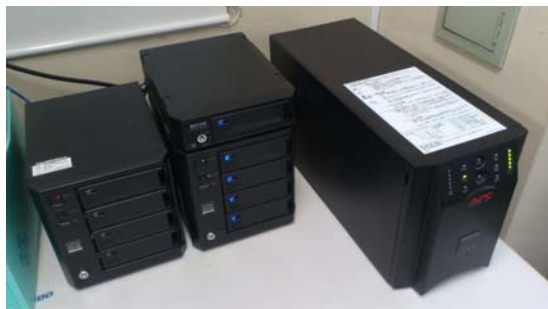
(停電対策に、NASとUPSを設置)
