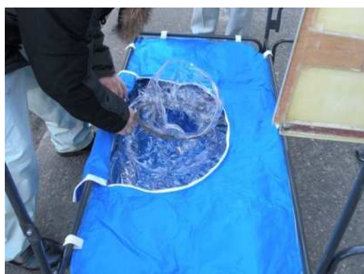
⑥便槽袋を床板の落とし口に合わせて整える。
