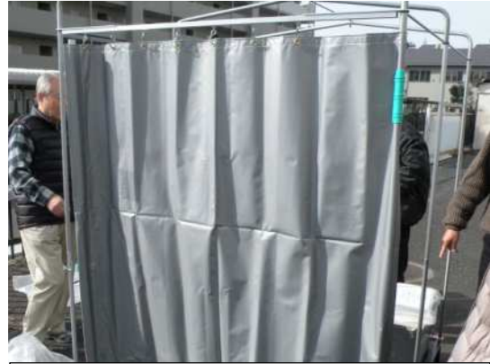
⑧カーテンをレールのフックにかける(ポケットが付いている方が外側になる)。
