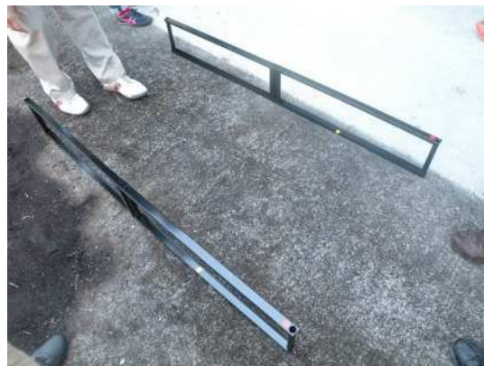
②袖金具を左右に延ばす。切り込みが入っている部分(黄色シール)が内側で向き合うように置く。
