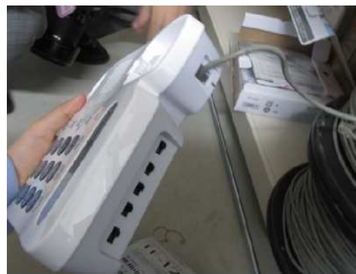
特設公衆電話機とコードの接続 ※電話機の「回線切替」を「トーン」にすること
