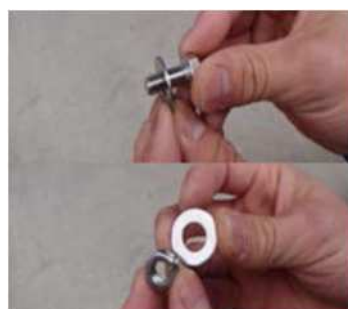
④ネジはワッシャーを付けて使用する(ナット側も)。
