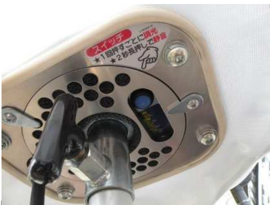
⑤プラグを差し込むとバルーンが自動で膨らむ。光量はスイッチで調整する。
