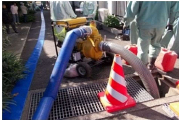
図 7-4-5 移動式ポンプ機(設置事例)
