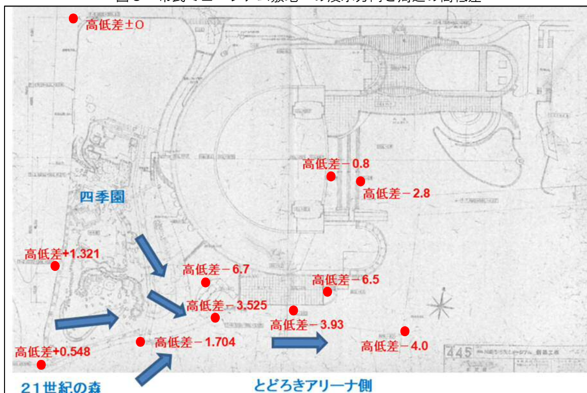
図8：市民ミュージアム敷地への浸水方向と周辺の高低差
