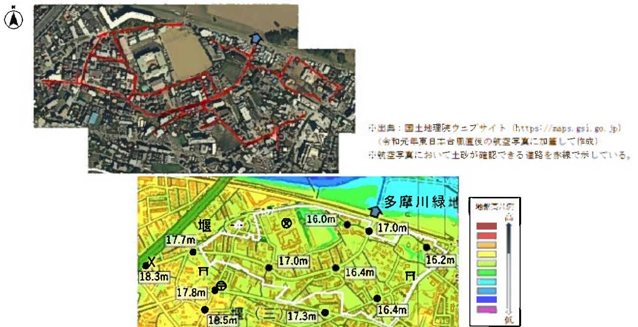
図5-5-2 宇奈根排水樋管周辺の浸水発生区域と地盤高
