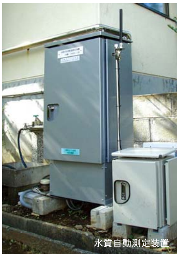
水道水の色やにごり、消毒の効果(遊離残留塩素)は、市内20か所に設置している水質自動測定装置で測定しています。
