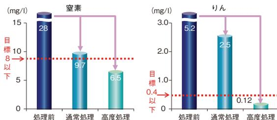
H23年度稼働した高度処理施設処理前後の水質 (入江崎水処理センター)
