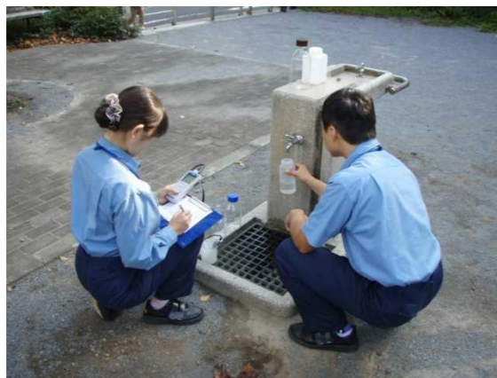
給水栓での採水作業
