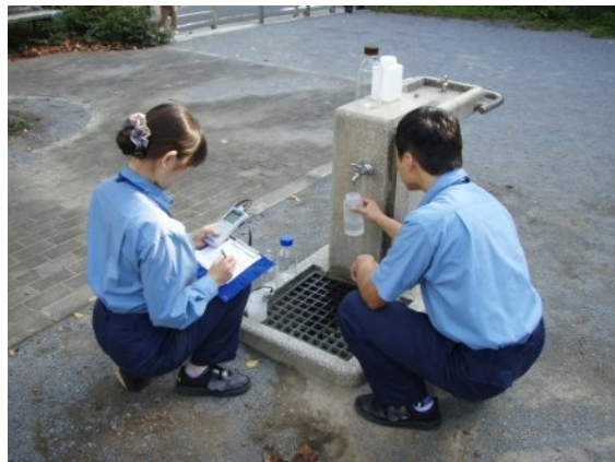
給水栓での採水作業
