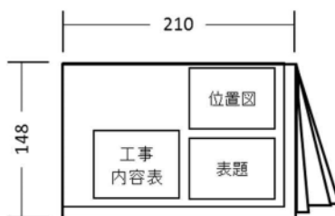
図1 図面の折り方(単位：mm)
