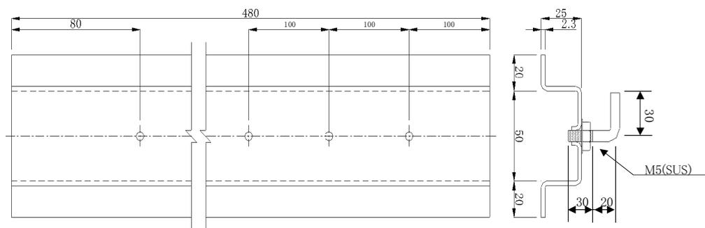
防噴流形通気孔(SUS製)
