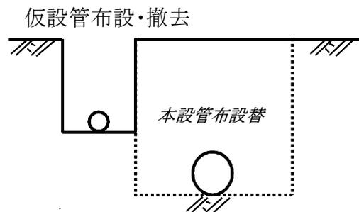
1. 原則、仮設管は本設管布設替位置より民地側を掘削することとし、他の埋設物に影響のないよう埋設箇所を選定すること。
