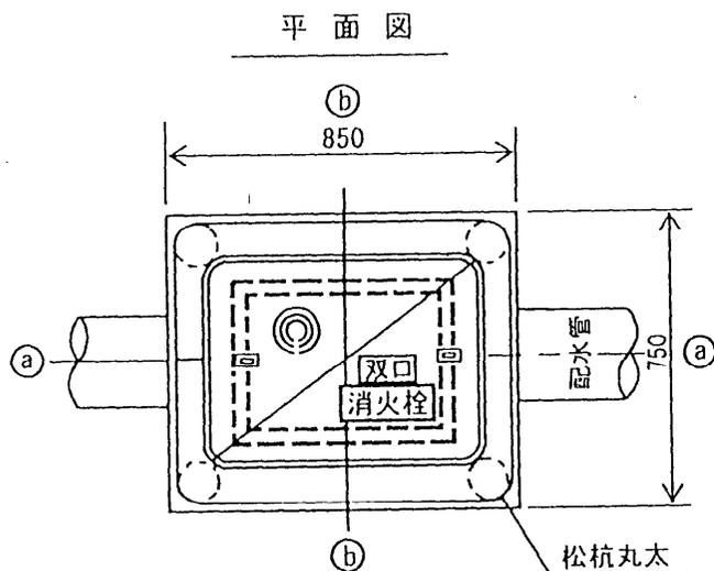
道路中央から消火栓と読み読めるように、上枠を据え付ける
