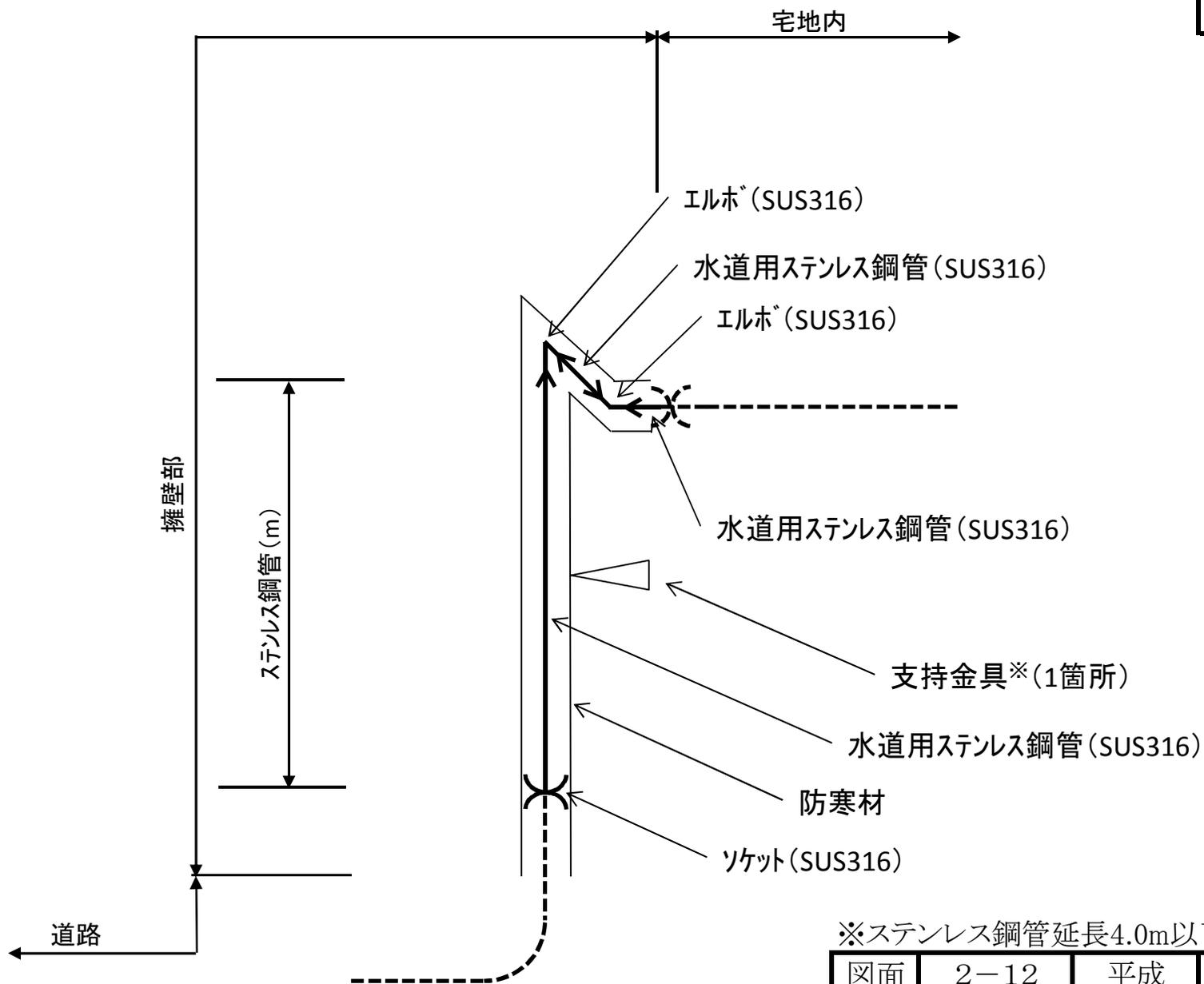
※ステンレス鋼管延長4.0m以下の場合
