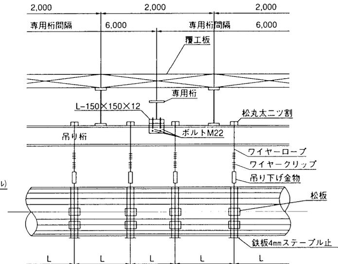
吊り桁取付詳細図
