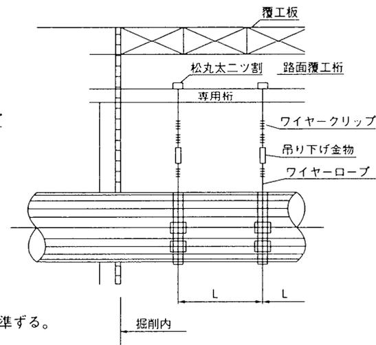
[注] 吊り間隔及び吊り材は縦断箇所の場合に準ずる。
