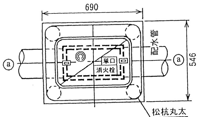
道路中央から消火栓と読めるように、上枠を据付る
