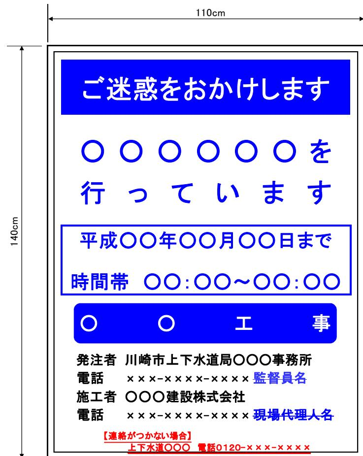
**表1 標示板(工事中看板)水道工事における工事看板内容表示例**
