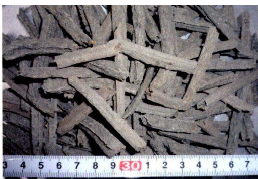
汚泥燃料化物
