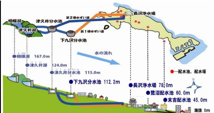
自然流下による水道システム
