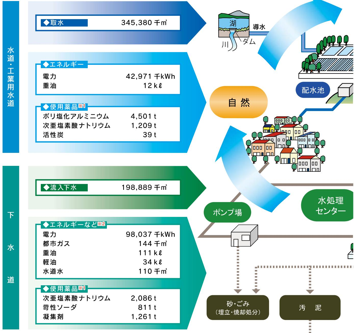
※1 ◇ポリ塩化アルミニウム：水道の原水や下水に添加することで、水中の汚れを凝集して、沈殿しやすくなります。
