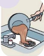
在下水道管道内冷却凝固，管道堵塞导致下水不流动。
