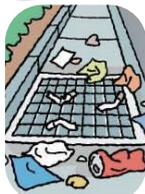
如果向路边雨水井里倒垃圾，下水道管就会堵塞，雨水漫过路面。另外，降雨时垃圾等可能会流入大海、河流等处。
