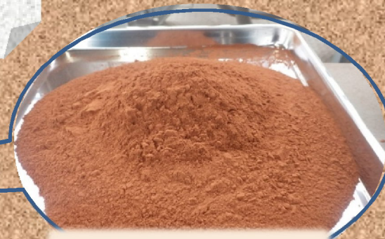
焼却灰のセメント原料化
