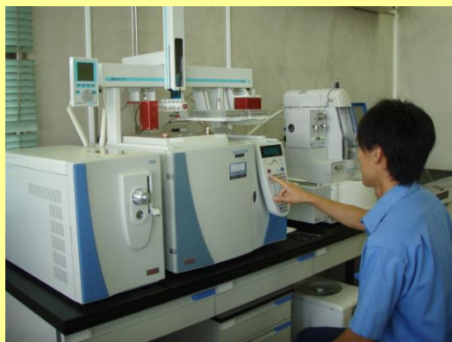
ガスクロマトグラフ質量分析装置 揮発性有機化合物等の測定に用いる
