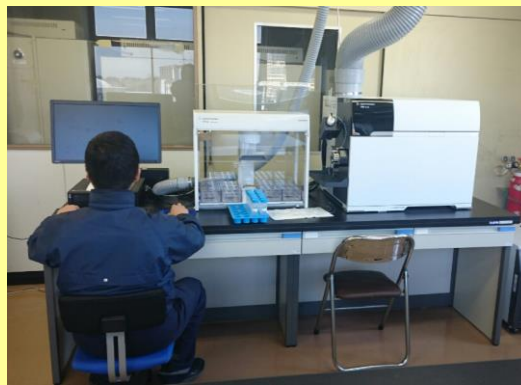
ICP質量分析装置 金属類の測定に用いる
