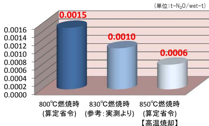
燃焼温度によるN<sub>2</sub>O排出量の比較
