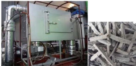
下水汚泥燃料化物の製造装置及び製造物
