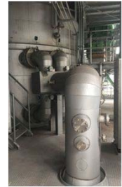
一酸化二窒素と窒素酸化物の削減効果を確認する試験設備
