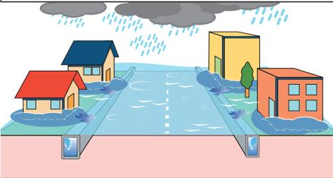
対策前：下水管きよの能力を超える雨水により浸水が発生
