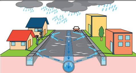
対策後：貯留管や導水管の整備により既設下水管きよの負担を軽減
