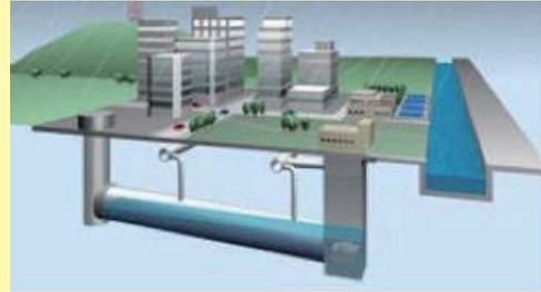
[目的] 比較的汚れを多く含む降雨初期の雨水を一時的に貯留することで、雨天時の放流回数を削減するとともに、放流水質が向上します。
