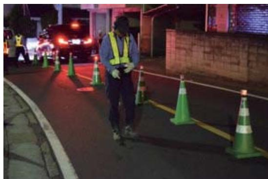
電子式漏水発見器による調査
