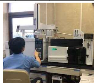
ガスクロマトグラフ質量分析計による水道水の水質検査
