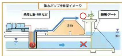
○排水ポンプ車の車両規格や排水能力は、想定される現場排水作業の実現性を条件に、最大限の規格や能力で選定するのが効果的であり、道路幅等の現地条件、人力による作業性などを考慮し、詳細仕様を選定。
