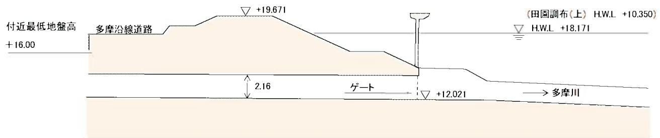
図 4-5-1 宇奈根排水樋管の概要と縦断面図
