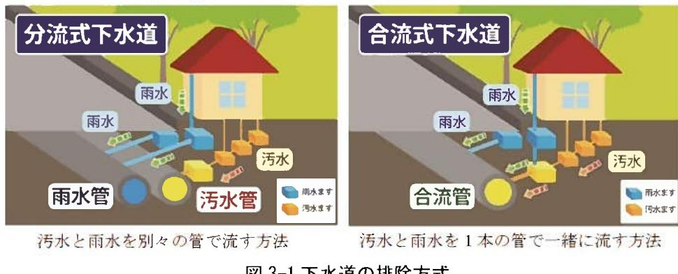
図3-1 下水道の排除方式
