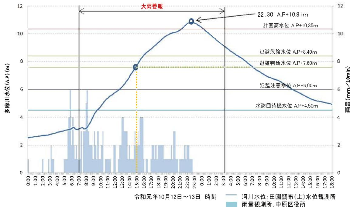
図 6-4-1 京浜河川事務所田園調布（上）水位観測所で記録された多摩川の水位
