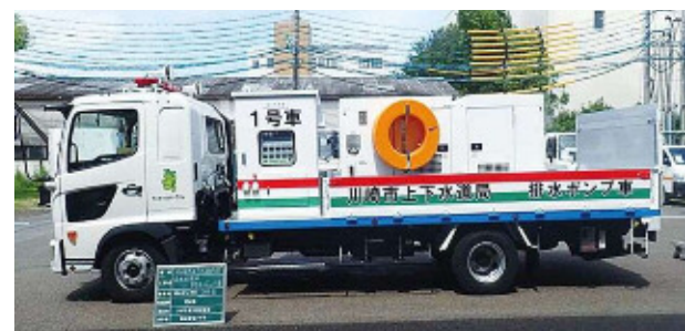
排水ポンプ車(30m 3 /分排水可能)
