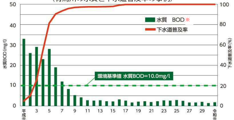
下水道の普及による河川の水質改善効果 (有馬川の水質と下水道普及率の事例)
