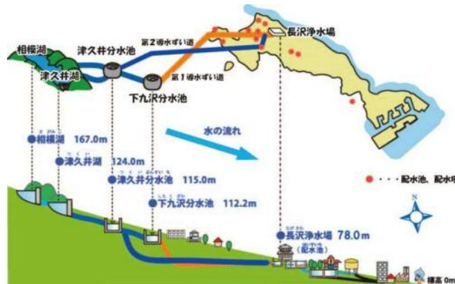
自然流下による水道システム
