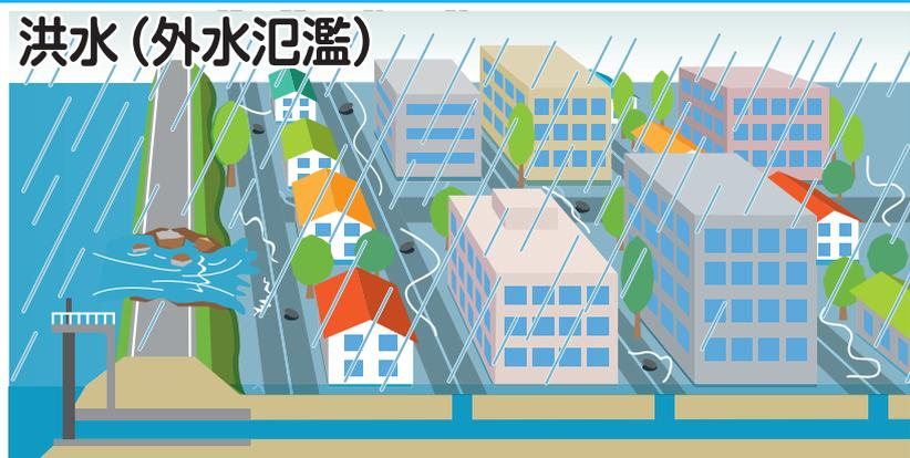
『洪水(外水氾濫)』とは、大雨によって河川の水位が高くなった時、堤防を越えて水があふれたり、堤防が決壊したりする現象です。
