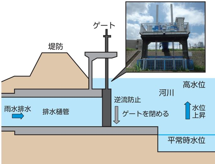
「排水樋管」は下水道から河川に雨水を排水する箇所に設けられる施設です。
