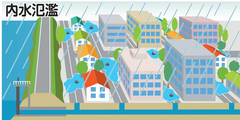
『内水氾濫』とは、下水道等の排水施設の能力を超えた雨が降った時や、雨水の排水先の河川の水位が高くなった時等に、雨水が排水できなくなり浸水する現象です。
