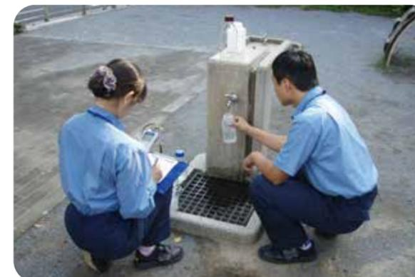
定期水質検査の採水作業
