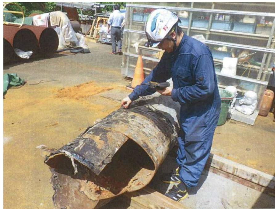
撤去管の劣化度調査(管厚測定)
