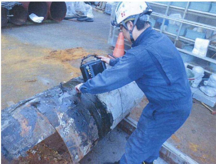
撤去管の劣化度調査(超音波探傷検査)
