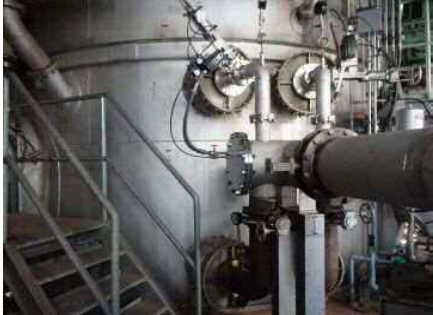
一酸化二窒素と窒素酸化物の削減効果を確認する試験設備
