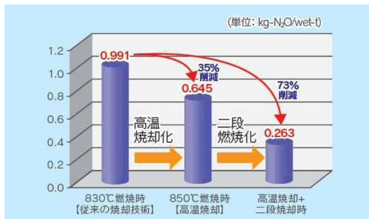
燃焼温度によるN 2 O排出量の比較
