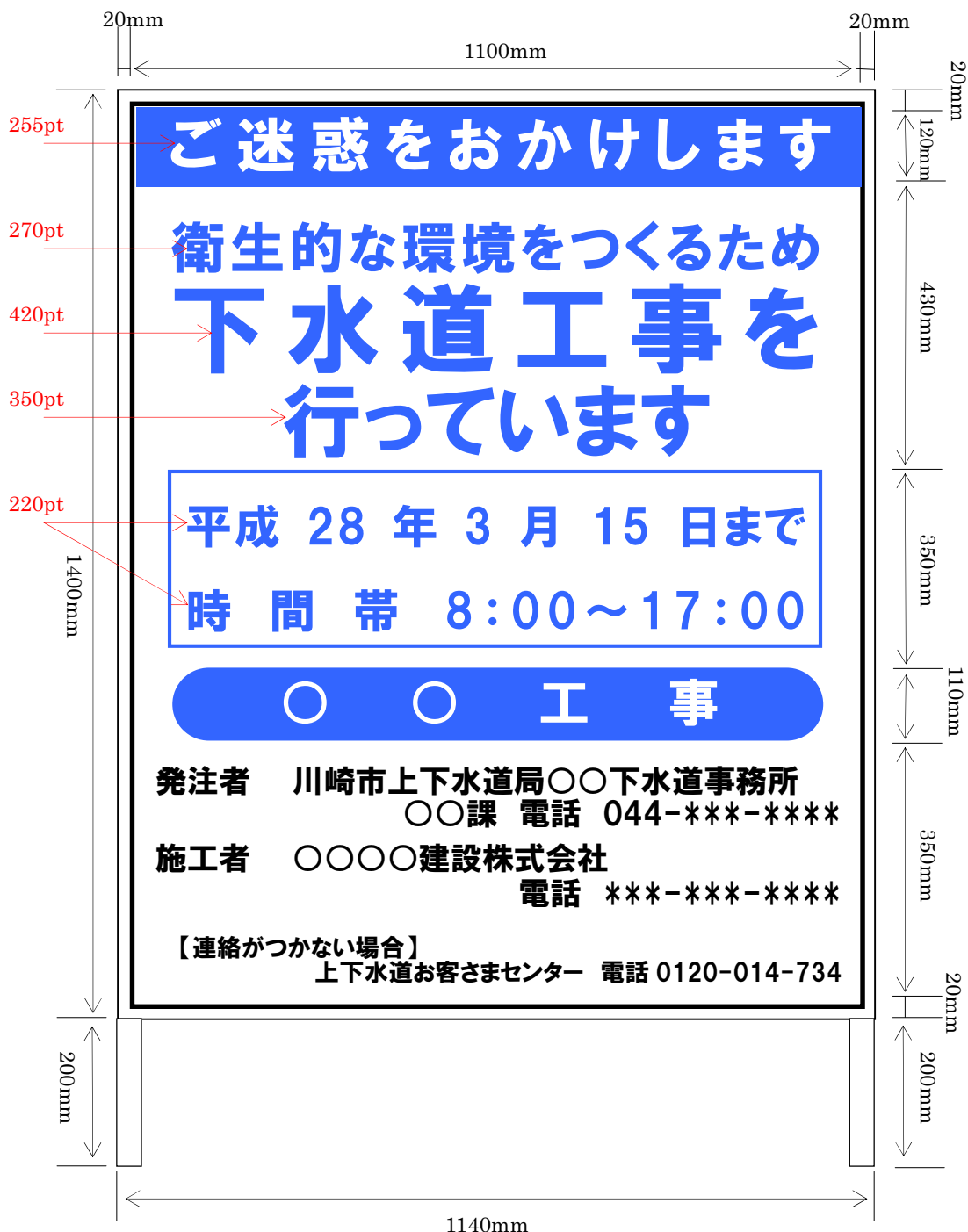
図-1 ①工事中標示板の標準様式
