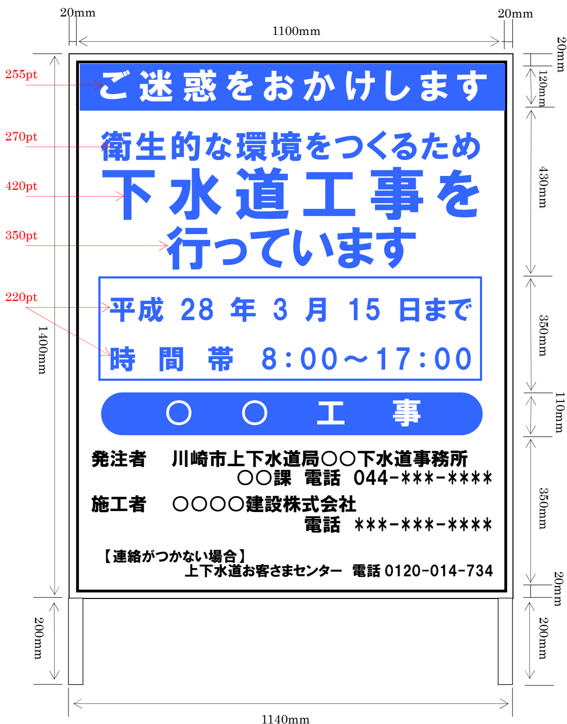
図-1 ①工事中標示板の標準様式
