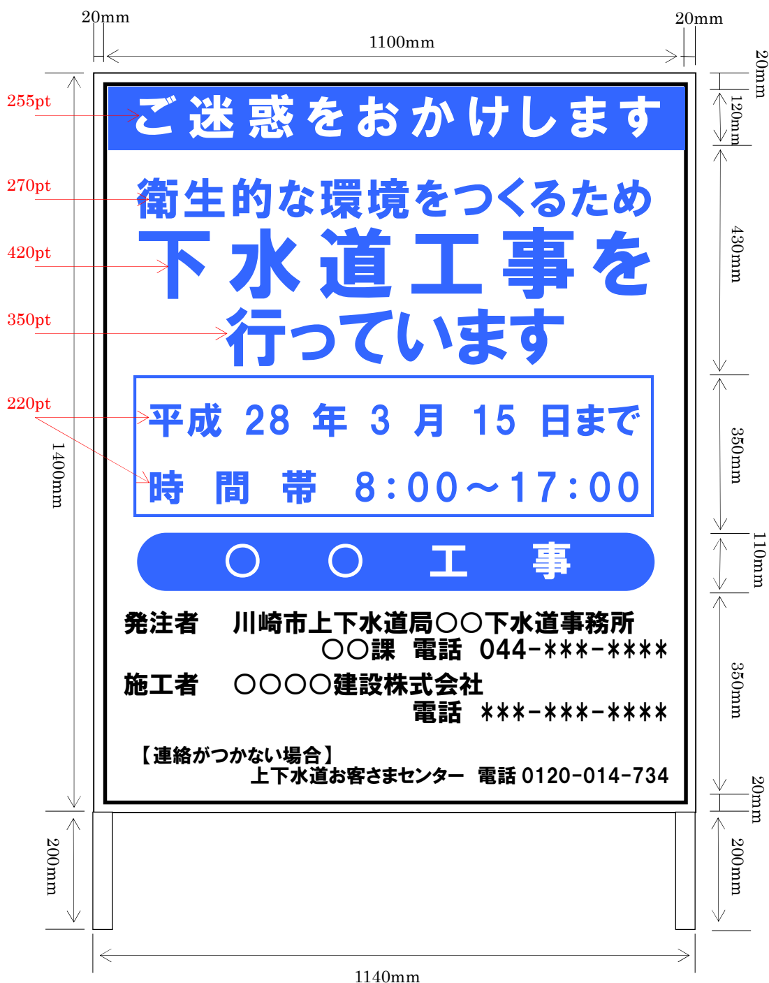
図-1 ①工事中標示板の標準様式
