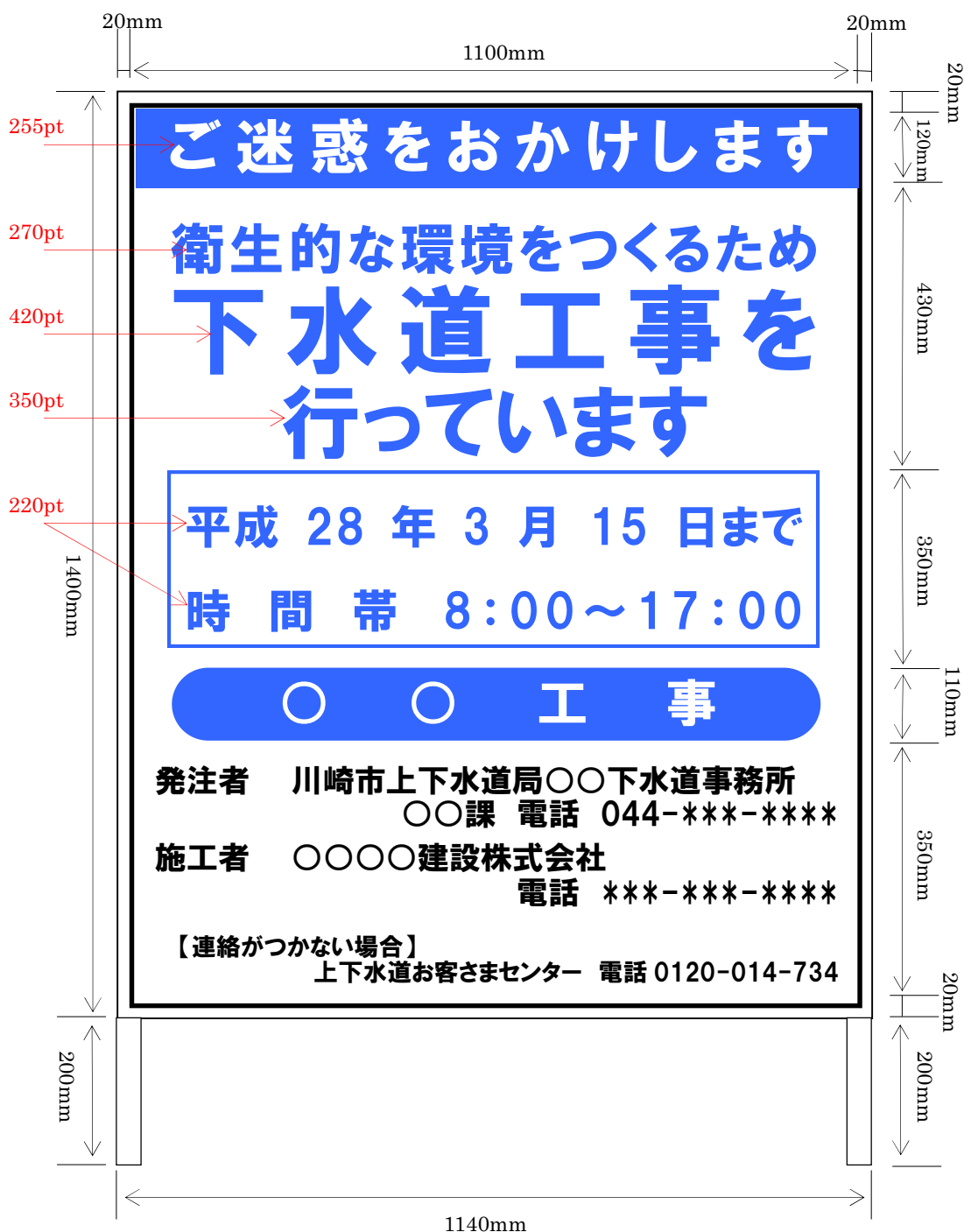
図-1 ①工事中標示板の標準様式
