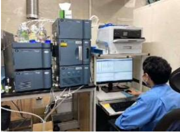
ガスクロマトグラフ-質量分析計による水道水の水質検査
