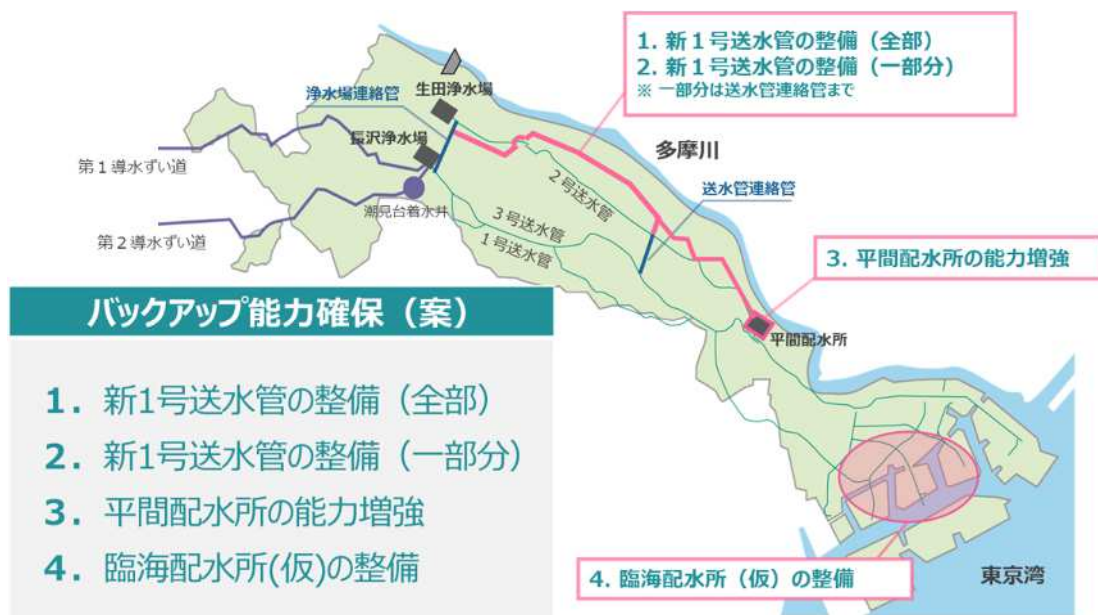
図 18 比較検討案の概要（計画給水量 39 万 m 3 /日）
