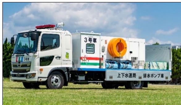
排水ポンプ車
