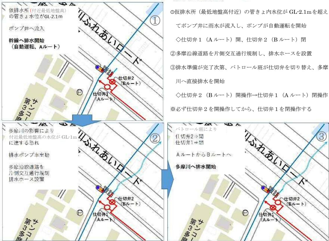
○仮排水所（最低地盤高付近）の管きょ内水位がGL-2.1mを超えてポンプ井に雨水が流入し、ポンプが自動運転を開始
