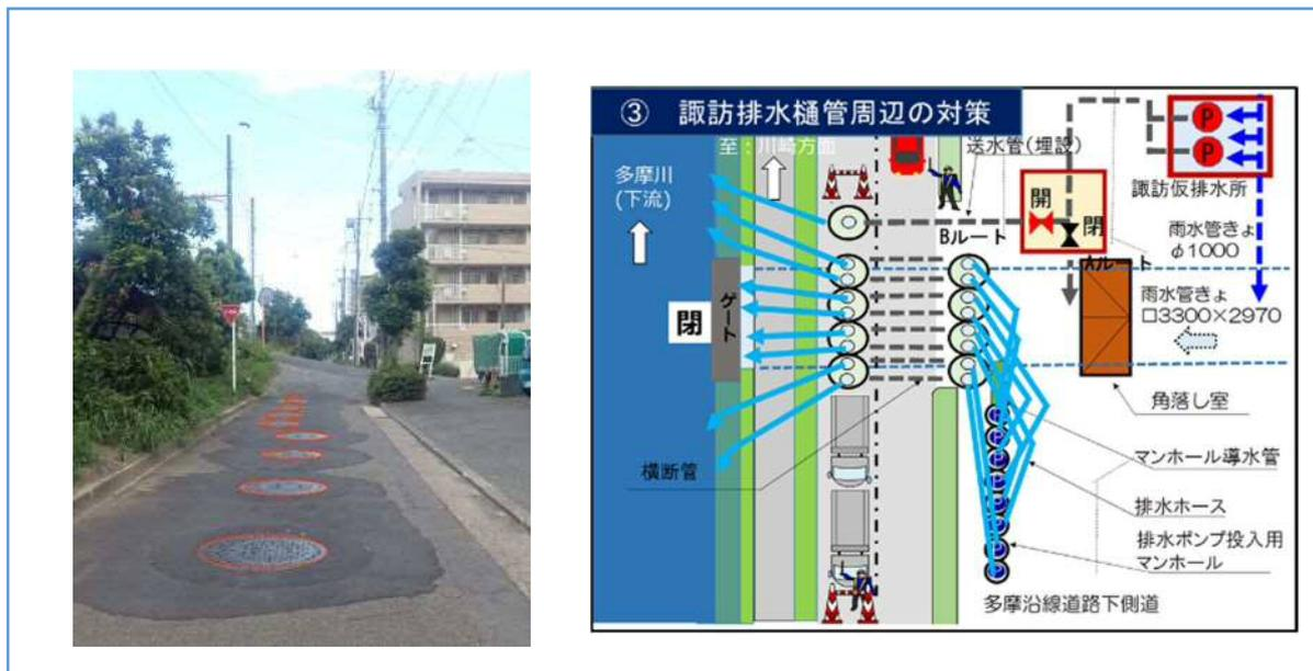
図 2 - 1 1 諏訪排水樋管 排水ポンプ投入用マンホール詳細図
