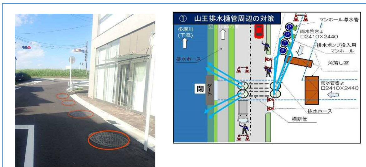
図 2 - 7 山王排水樋管 排水ポンプ投入用マンホール詳細図
