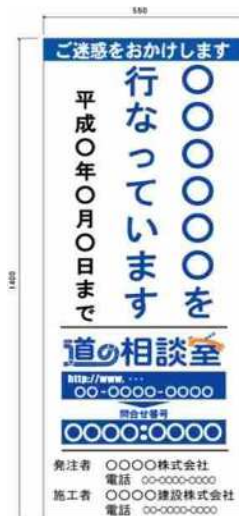
※様式4 工事説明看板
